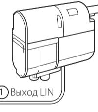
К разъему X5 базового блока системы
