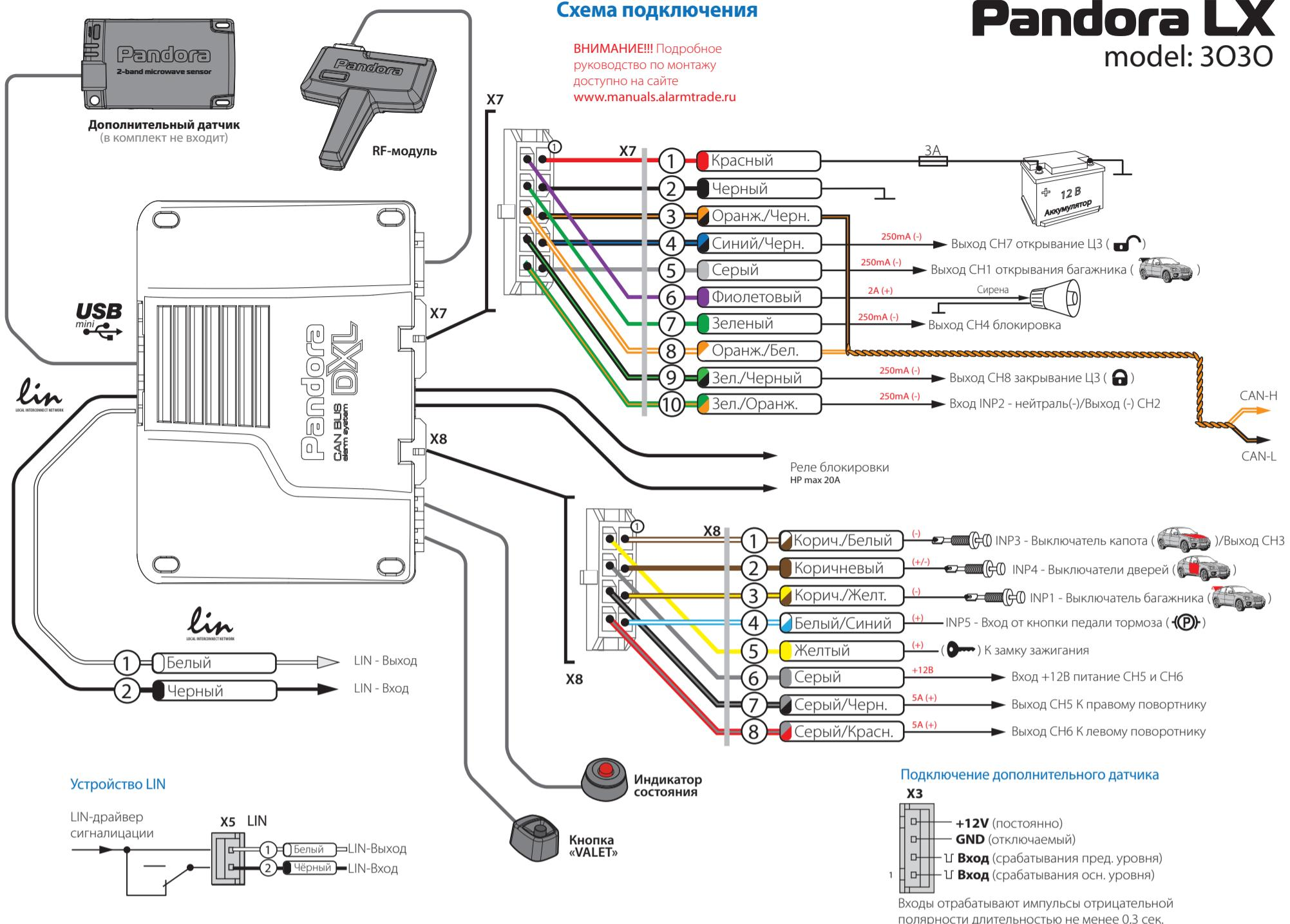
Разъёмы базового блока
