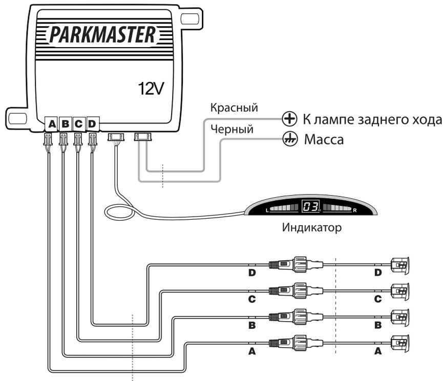
Данная схема подключения для парковочных систем 4BJ/DJ06, 4BJ10, 4BJ/DJ13 и 4BJ/DJ14
