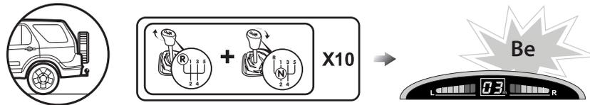
Включите зажигание, переместите ручку коробки передач из позиции N в позицию R 10 раз с интервалом в 1 сек. На 10-ый раз останьтесь в позиции R на 6 сек. Это активизирует функцию запоминания и система больше не будет реагировать на выносной элемент автомобиля. Включите зажигание, переместите ручку коробки передач из позиции N в позицию R 12 раз с интервалом в 1 сек. На 12-ый раз останьтесь в позиции R на 8 сек. Это обнулит функцию запоминания.
