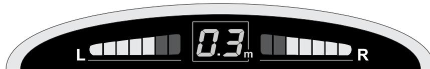
индикатор устанавливается на приборную панель автомобиля
