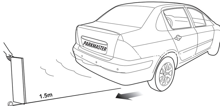
Данный тест возможен с применением плоской деревянной доски размерами 30x100см: держите ее позади автомобиля и двигайтесь задним ходом для проверки каждого датчика системы, как показано на рисунке.
