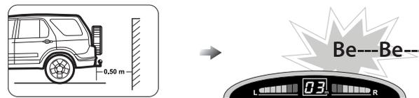
При программировании функции запоминания все ультразвуковые датчики должны быть подключены к системе. Если при программировании какой-либо датчик был отключен, то при его дальнейшем подключении индикатор будет показывать постоянное наличие препятствия по соответствующему каналу. Данная ошибка устраняется повторным перепрограммированием системы со всеми датчиками.
