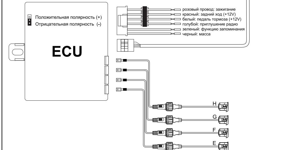
Для автомобилей, оборудованных CAN-шиной, используйте дополнительное реле в цепи питания системы парковки.
