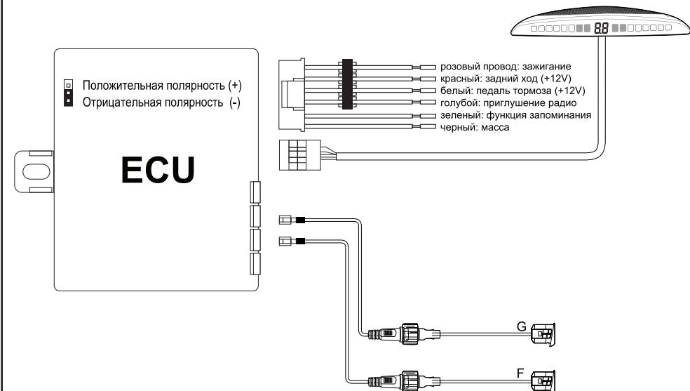
Для автомобилей, оборудованных CAN-шиной, используйте дополнительное реле в цепи питания системы парковки.
