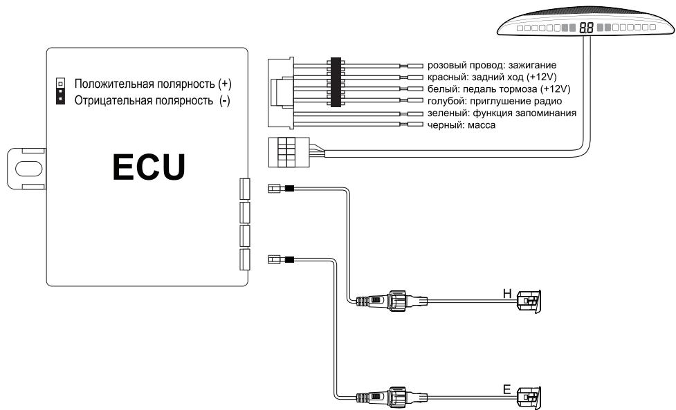
Для автомобилей, оборудованных CAN-шиной, используйте дополнительное реле в цепи питания системы парковки.
