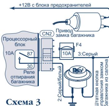
багажника. Сигнал на этом проводе может быть как положительным, так и отрицательным, в зависимости от подключения серого провода. Это контакт № 30 внутреннего реле управления замком багажника.
