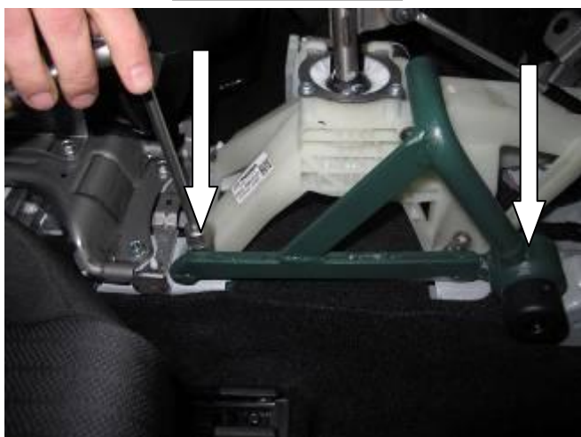
Установить замок на шпильки, закрутить 2 срывные гайки
