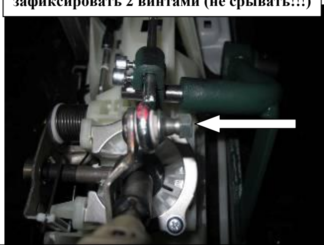
Установить срывную гайку на место штатной
