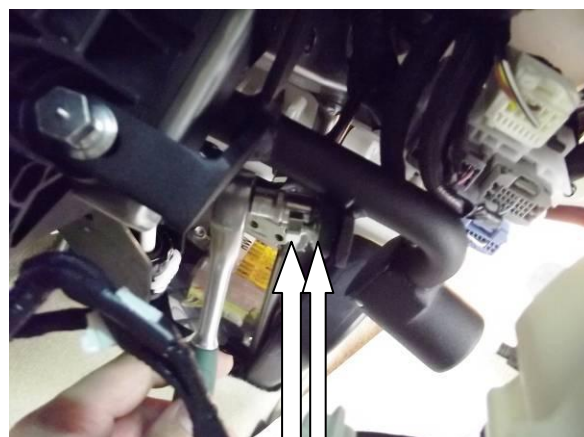
Зафиксировать пластину-держатель на замке 2 срывными болтами (не срывать!!!)
