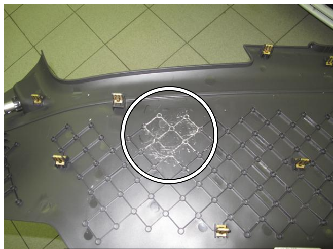
Удалить мешающие рёбра жёсткости консоли
