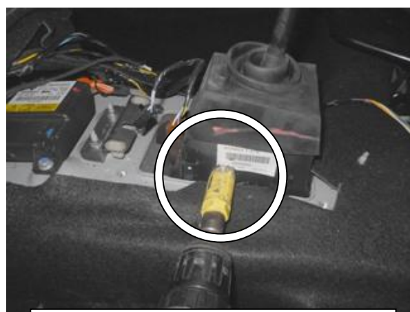
Просверлить в селекторе отверстие 22 мм. под трубу замка
