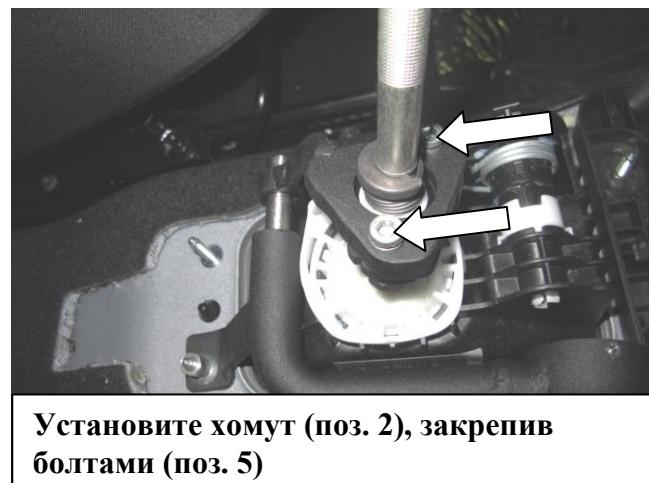
Установите хомут (поз. 2), закрепив болтами (поз. 5)
