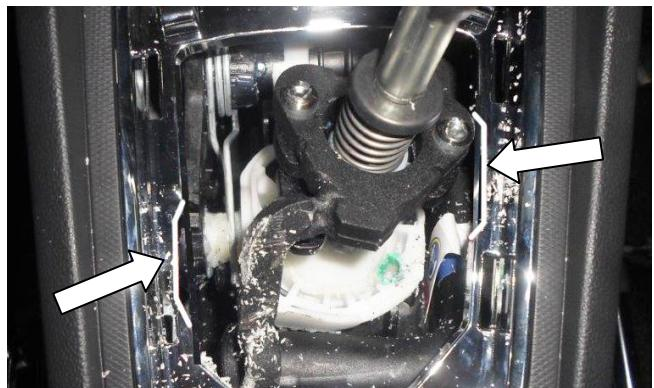
При необходимости подрежьте два ребра верхней накладки консоли
