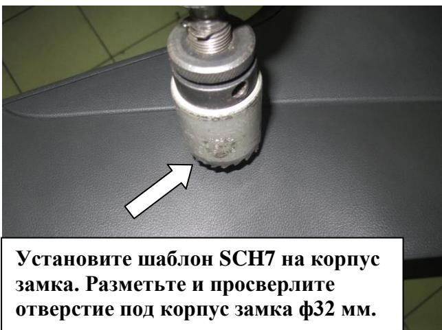
Установите шаблон SCH7 на корпус замка. Разметьте и просверлите отверстие под корпус замка ф32 мм.
