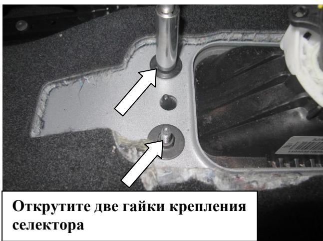
Открутите две гайки крепления селектора
