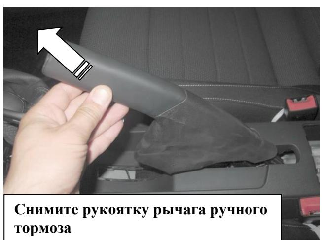
Снимите рукоятку рычага ручного тормоза
