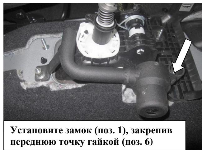
Установите замок (поз. 1), закрепив переднюю точку гайкой (поз. 6)
