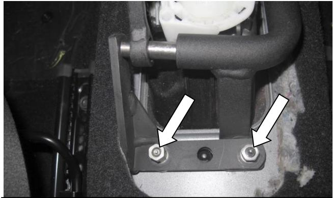
Установите защиту (поз. 4), закрепив гайками (поз. 6) с шайбами (поз. 7)
