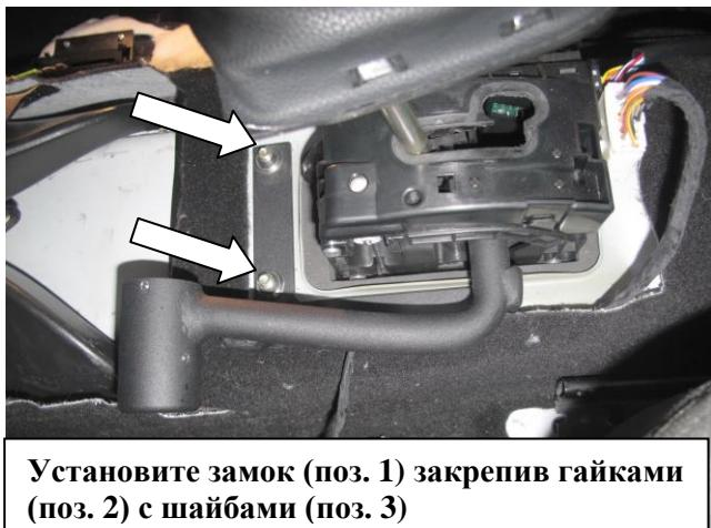
Установите замок (поз. 1) закрепив гайками (поз. 2) с шайбами (поз. 3)
