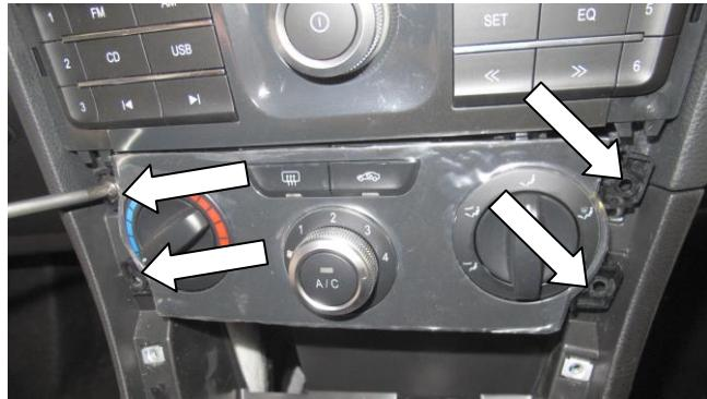
Открутите четыре самореза крепления накладки консоли и снимите накладку консоли
