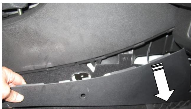
Открутите саморез крепления накладки консоли с обеих сторон и снимите накладки консоли
