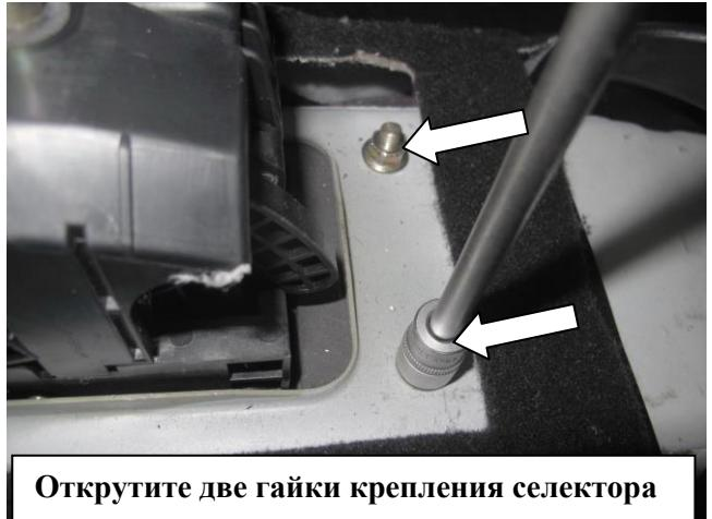
Открутите две гайки крепления селектора
