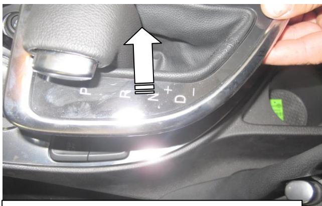
Снимите кожух рычага переключения передач КПП
