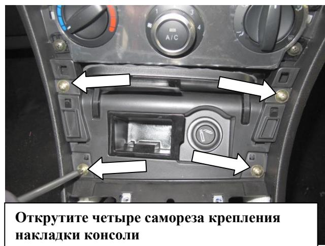
Открутите четыре самореза крепления накладки консоли
