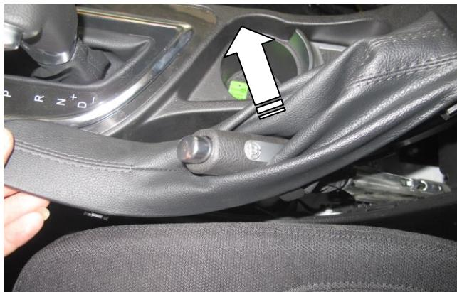
Снимите кожух рычага ручного тормоза
