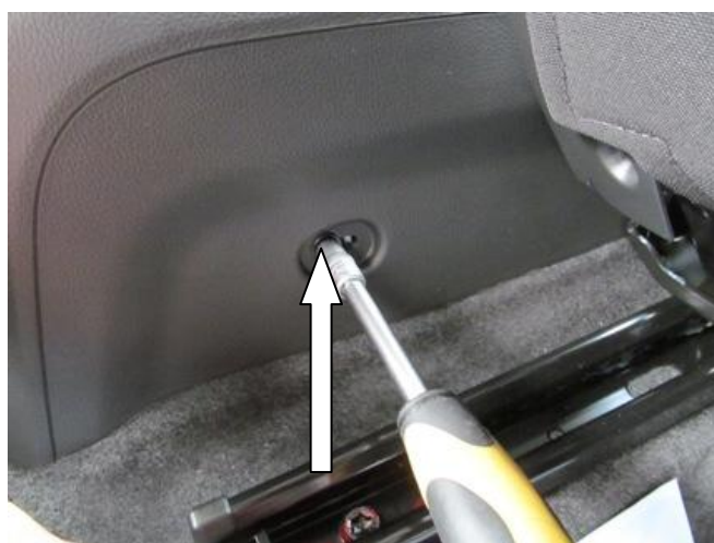
Сдвинуть кресло вперёд до упора, открутить саморез
