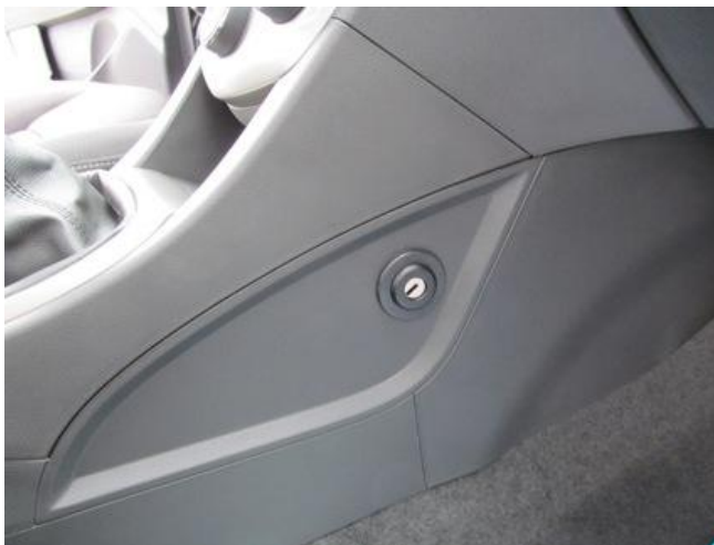
Разметить, используя разметочный шаблон, просверлить и расширить отверстие в консоли под корпус замка, установить консоль на место
