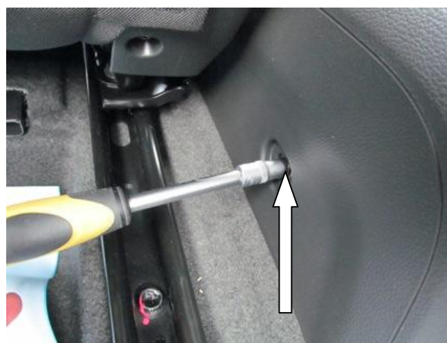
Сдвинуть кресло вперёд до упора, открутить саморез
