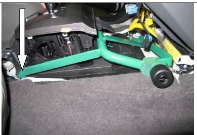
15 Зафиксировать лапку срывным болтом
