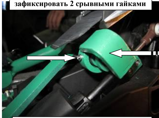
16 Установить защиту ригеля на трубу замка, зафиксировать винтом
