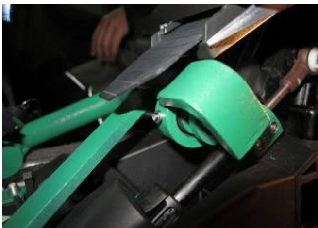
17 Перевести рычаг переключения передач в положение «Р», произвести и проверить блокировку, сорвать болт и 2 гайки
