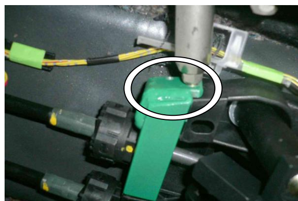
Зафиксировать защиту тяги на селекторе заклёпками и клёпальником
