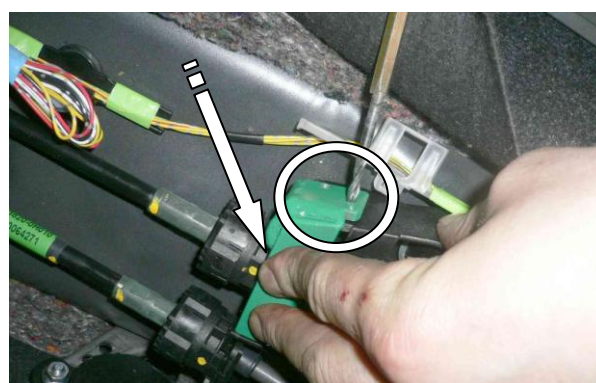
Установить защиту тяги, просверлить отверстия в селекторе через отверстия в защите
