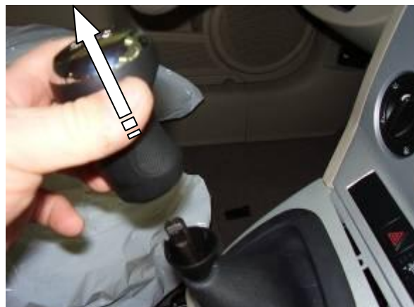
Снять рукоятку рычага переключения передач
