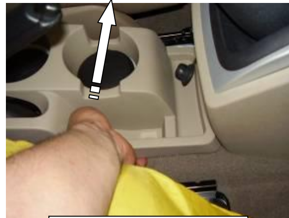
Снять верхнюю крышку
