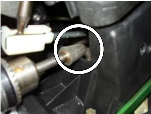
Удалить пластик селектора, мешающий установке хомута
