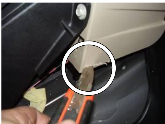
Удалить мешающий установке замка пластик консоли
