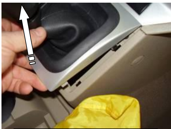
Снять декоративную крышку
