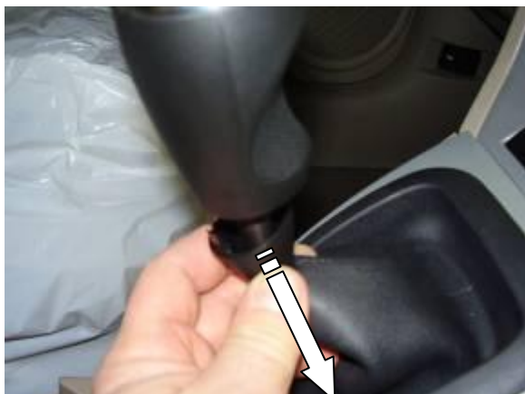
Снять декоративный колпак рукоятки рычага переключения передач
