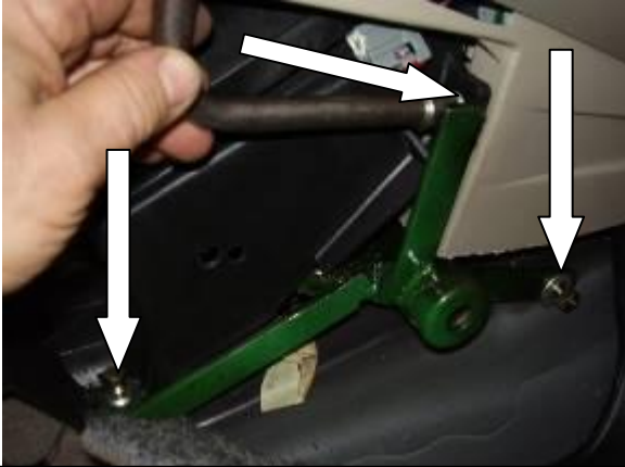
Установить замок, закрутить и болта
