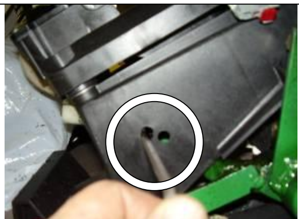
Установить рычаг переключения передач в положение «R», произвести блокировку хомута, зафиксировать хомут на тяге 2 винтами
