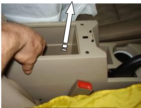
Снять заднюю консоль
