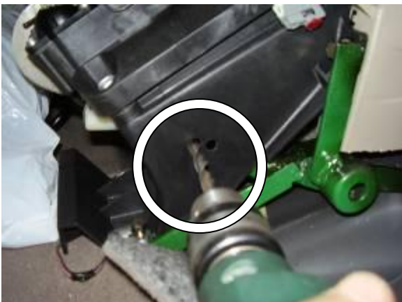
Просверлить технологические отверстия в селекторе
