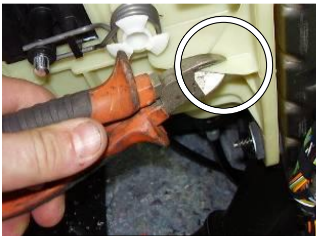
Удалить мешающий установке замка пластик селектора
