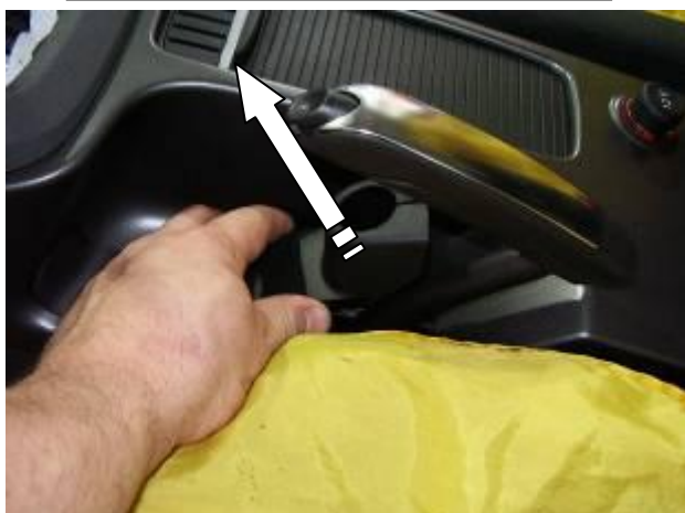
Снять крышку рычага стояночного тормоза
