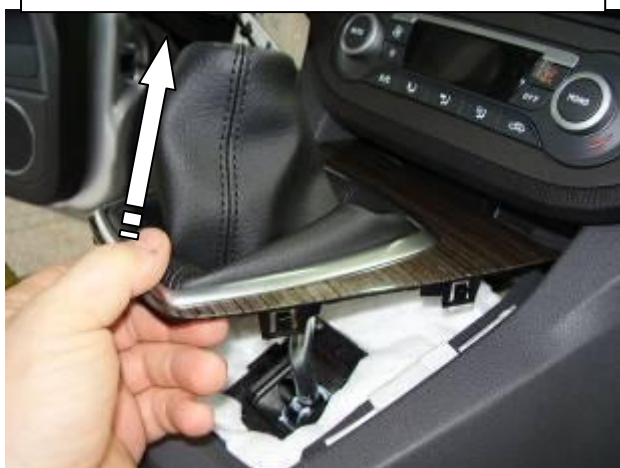
Снять декоративную крышку рычага переключения передач
