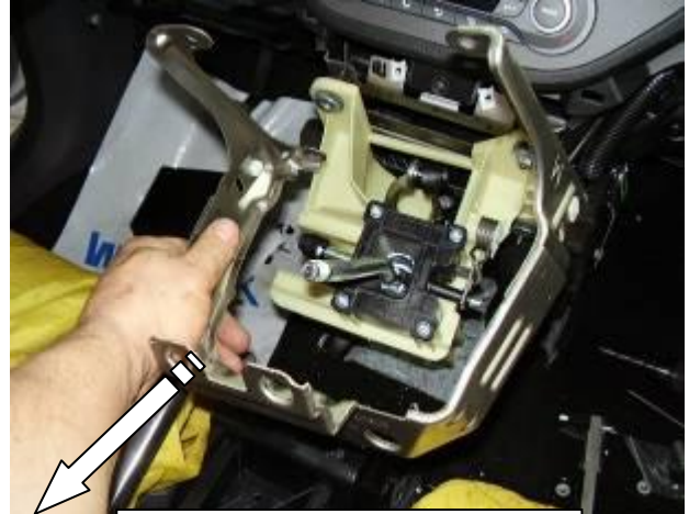
Снять держатель консоли
