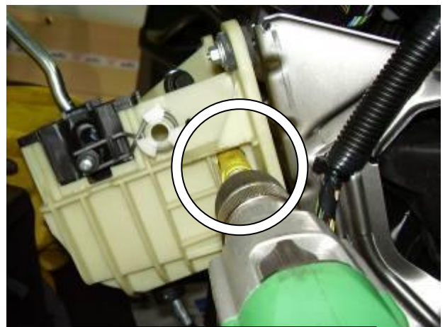
Просверлить отверстие в селекторе под трубу замка
