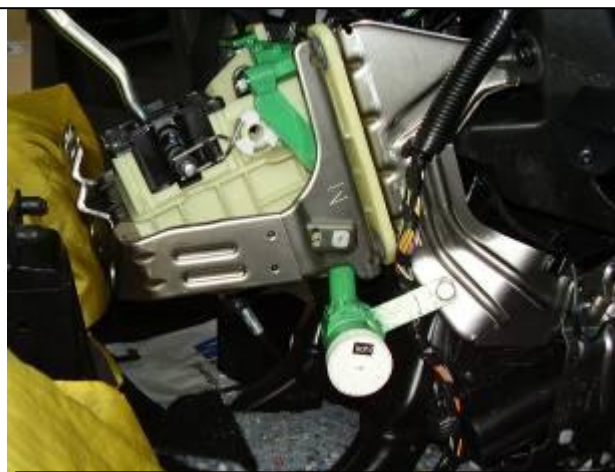
Разметить, используя разметочный шаблон, просверлить и расширить отверстие в консоли под корпус замка
