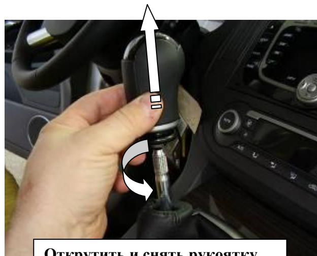
Открутить и снять рукоятку рычага переключения передач
