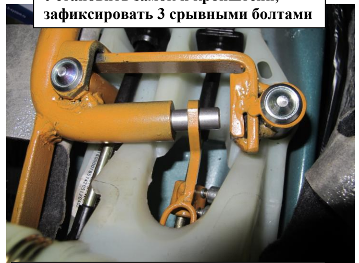
Перевести рычаг переключения передач в положение «R», произвести блокировку, отрегулировать положение хомута на тяге, сорвать винты 12
