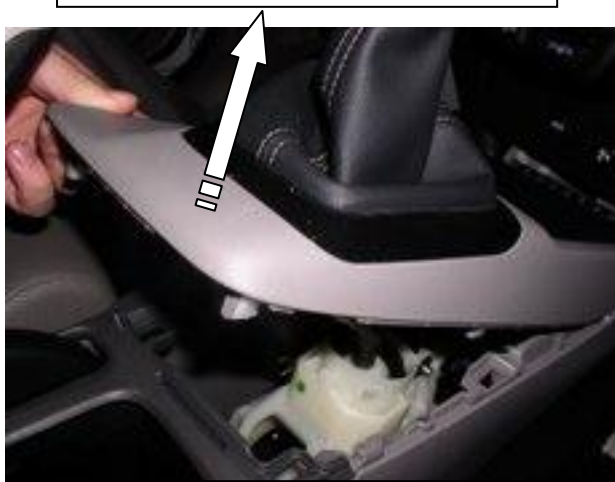
Снять переднюю верхнюю крышку
