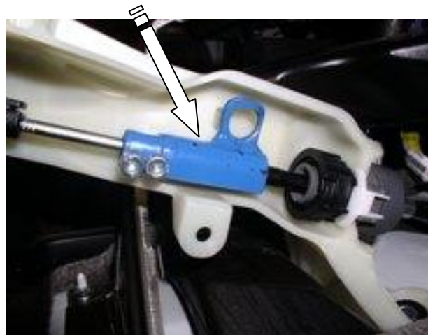
Установить хомут на тягу 14
