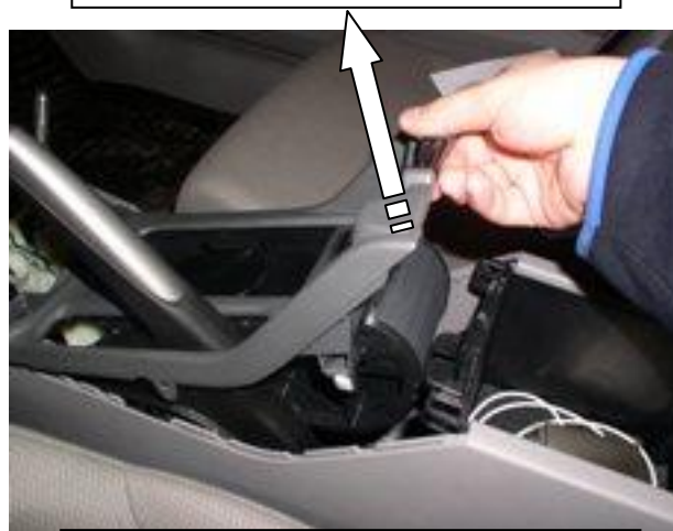
Снять заднюю верхнюю крышку
