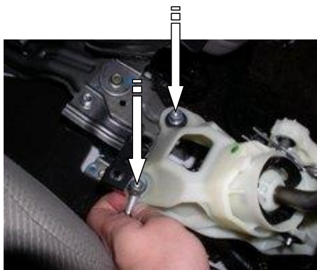
Заменить 2 штатных болта срывными М8 19
