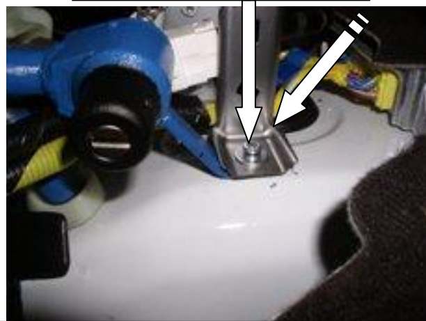
Установить замок, установить держатель консоли поверх лапки замка, закрутить болт М6 16
