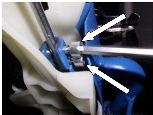
Зафиксировать хомут на тяге 2 винтами 18
