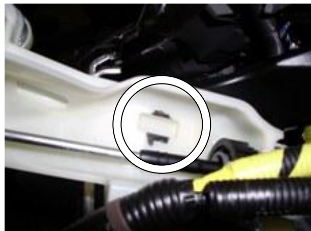
Разметить мешающий пластик селектора 20
