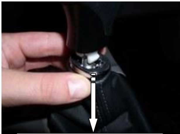
Снять декоративный кожух рычага переключения передач
