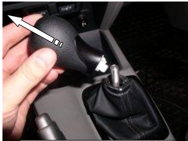
Открутить и снять рукоятку рычага переключения передач
