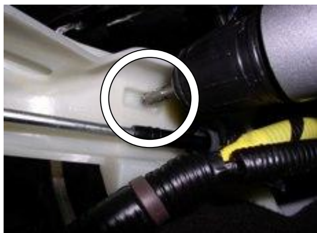
Удалить мешающий пластик селектора 21
