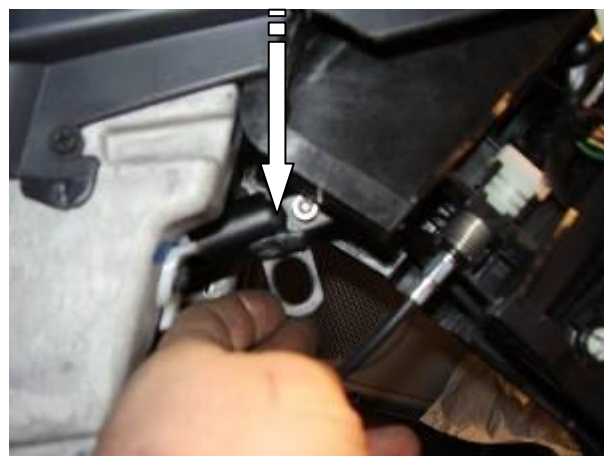
Установить хомут на тягу
