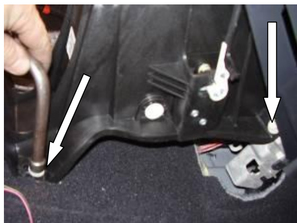
Открутить 2 штатных болта М6, заменить на срывные
