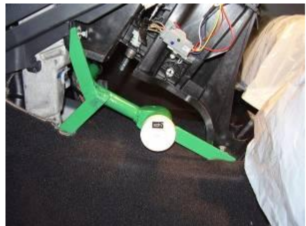
Разметить, используя разметочный шаблон, и просверлить отверстие в консоли под корпус замка
