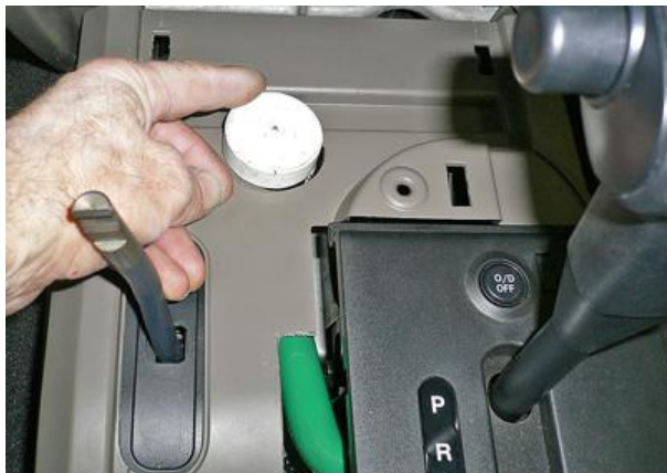
Разметить, используя разметочный шаблон, отверстие в верхней крышке под корпус замка
