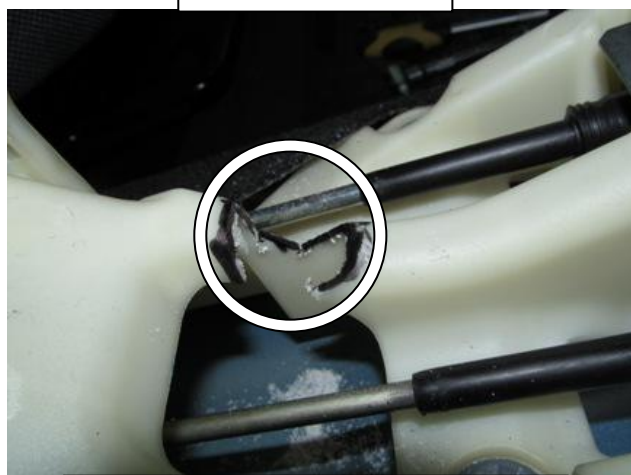
Удалить мешающий установке замка пластик селектора
