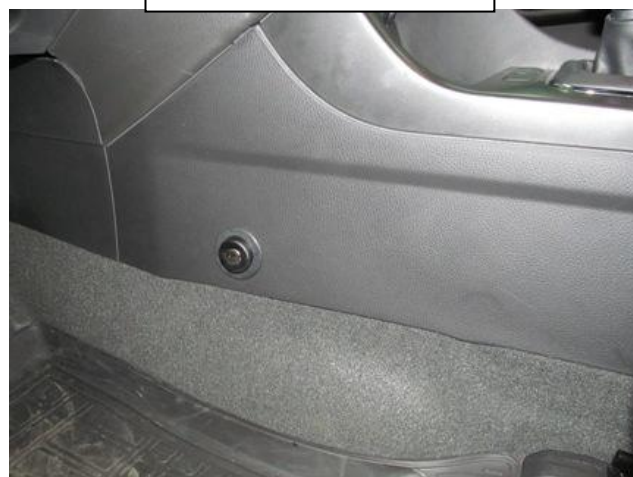
Разметить, используя разметочный шаблон, просверлить и расширить отверстие в консоли под корпус замка, установить консоль на место
