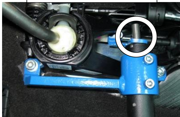
Перевести рычаг переключения передач в положение «R», произвести блокировку, отрегулировать положение хомута на тяге, зафиксировать хомут 2 винтами
