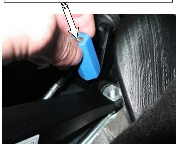
Установить шестигранный столбик на шпильку
