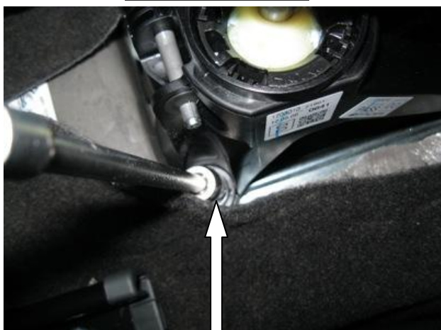
Открутить штатную гайку селектора
