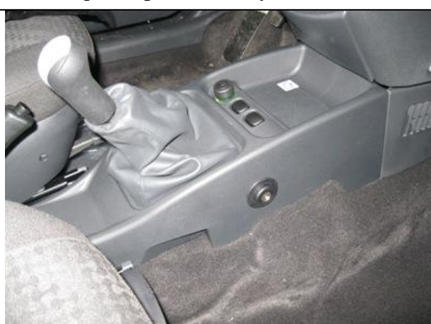
Разметить, используя разметочный шаблон, просверлить и расширить отверстие в консоли под прямоходный цилиндр, установить консоль на место
