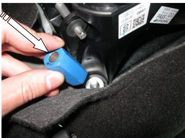
Установить шестигранный столбик на шпильку
