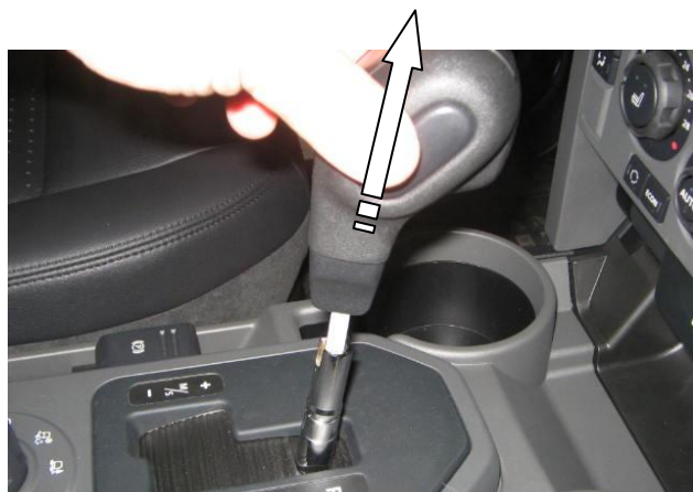
Снять рукоятку рычага переключения передач
