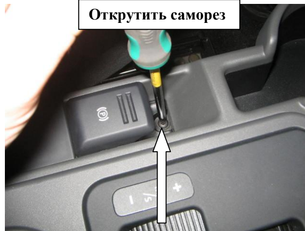
Снять рукоятку рычага переключения передач
