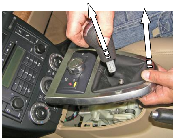
Снять рукоятку рычага переключения передач и верхнюю панель
