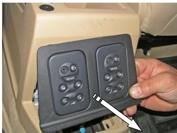
Снять заднюю панель
