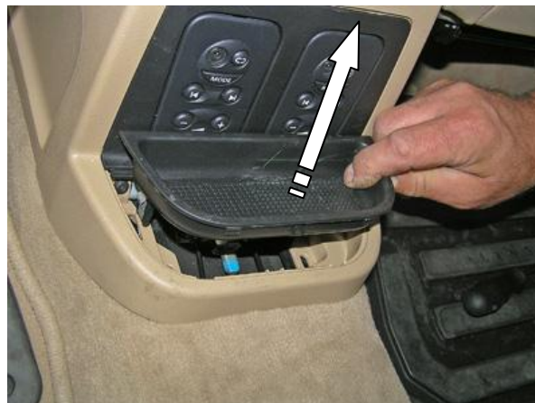
Снять заднюю крышку
