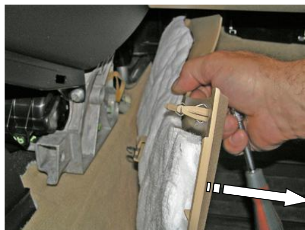
Снять боковую крышку
