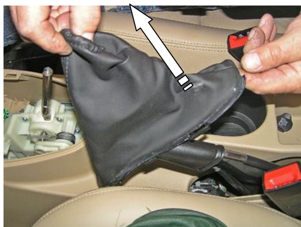
Снять декоративный чехол рычага стояночного тормоза
