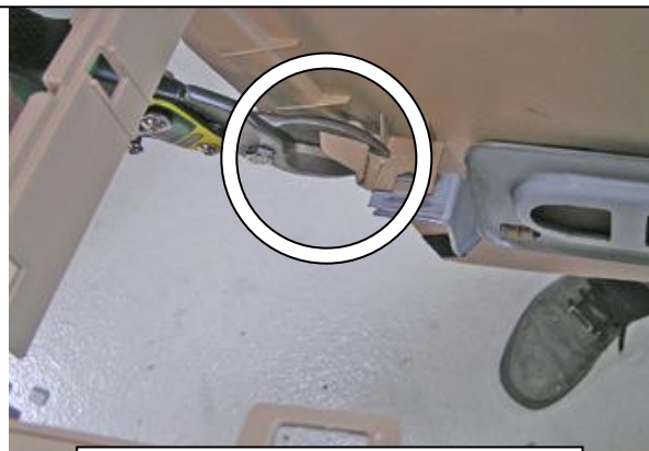
Удалить пластик консоли, мешающий установке замка
