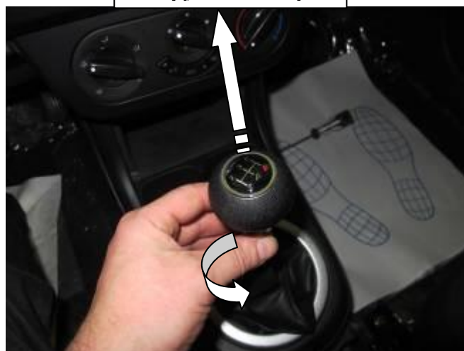
Открутить и снять рукоятку рычага переключения передач
