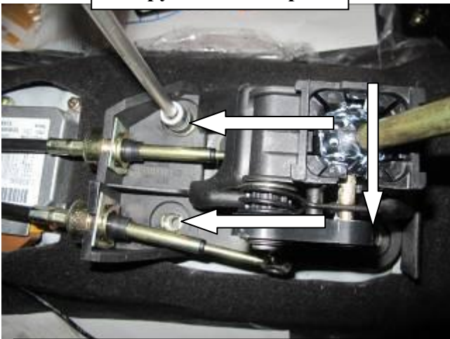
Открутить 3 штатных болта селектора
