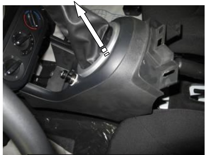
Снять переднюю консоль
