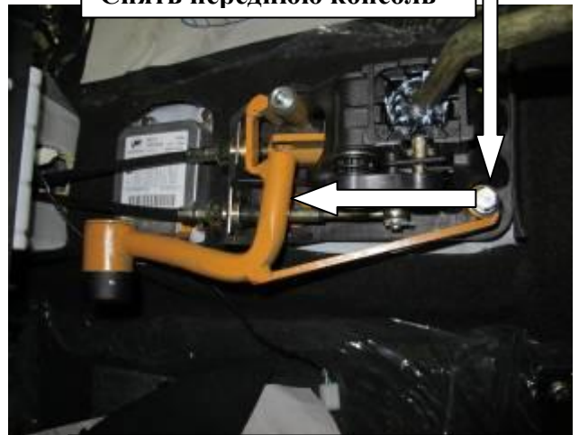
Установить замок, закрутить 2 штатных болта селектора
