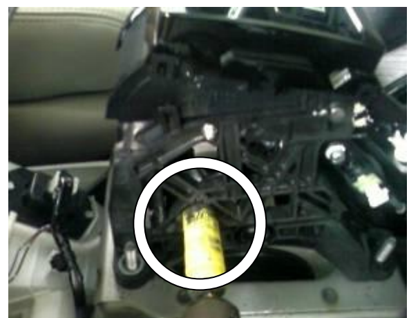
Просверлить отверстие 22 мм. в селекторе под трубу замка
