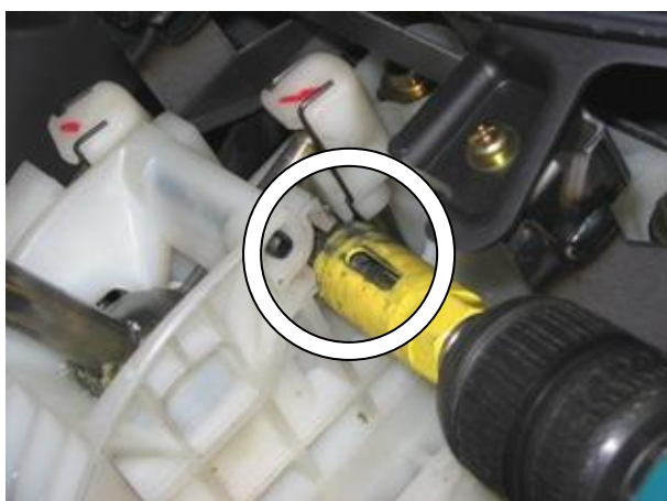
Просверлить отверстие в селекторе под трубу замка
