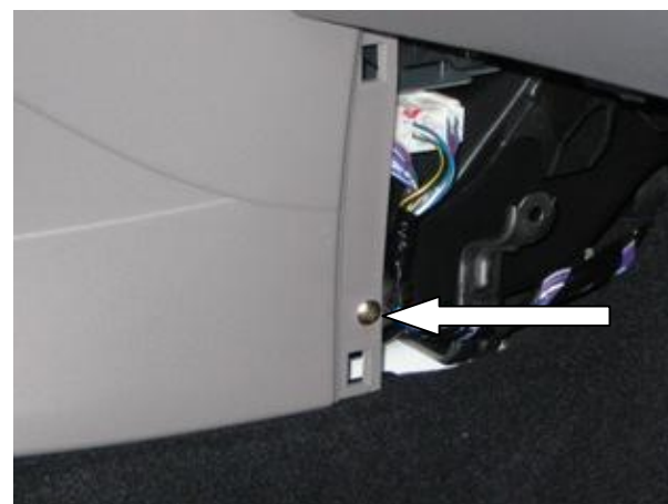
Открутить саморез с обеих сторон
