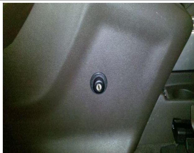
Разметить, используя разметочный шаблон, и просверлить отверстие в консоли под корпус замка, установить консоль на место
