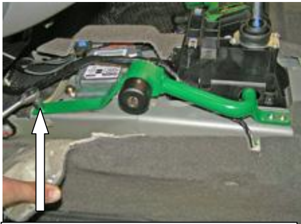
Открутить штатный болт селектора, установить замок трубой в отверстие
