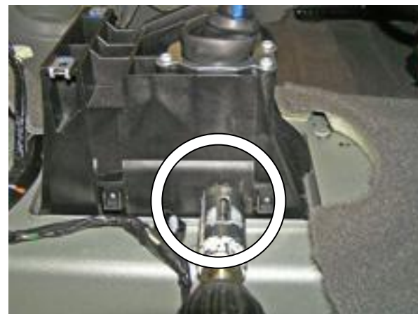
Расширить отверстие до 22 мм.
