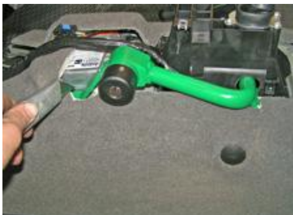
Вернуть ковровин на место, перевести рычаг переключения передач в положение «R», произвести и проверить блокировку рычага
