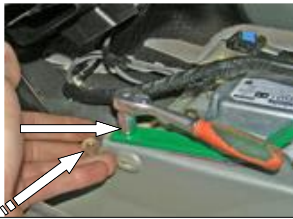
Зафиксировать лапку замка срывным болтом и несрывной гайкой с обратной стороны
