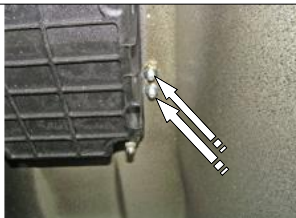
Зафиксировать лапку замка на днище 2 срывными болтами и 2 несрывными гайками с обратной стороны
