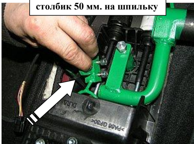
Установить хомут на тягу, зафиксировать 2 винтами (не срывать!!!)
