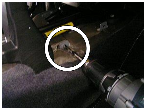
Расширить отверстие до 9 мм.
