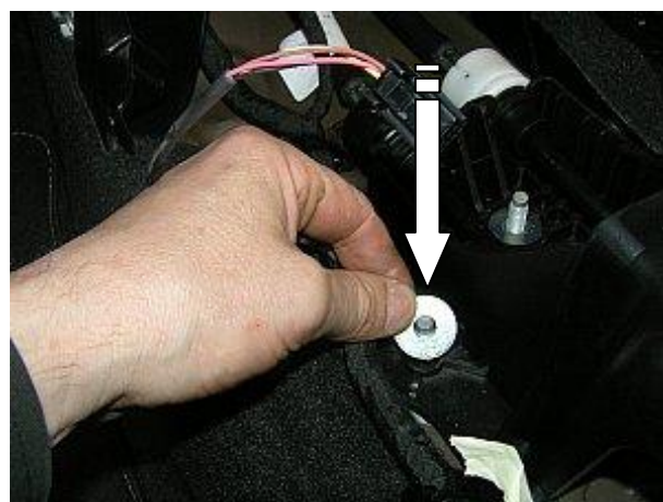
Подложить шайбу на шпильку
