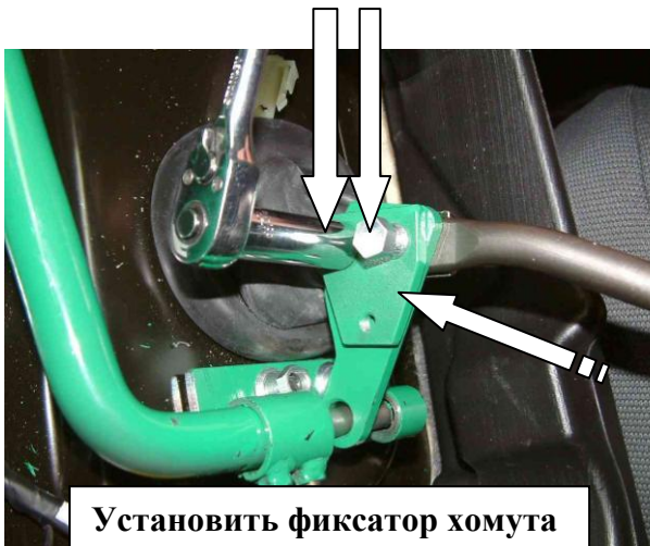
Установить хомут на рычаг, закрутить 2 болта
