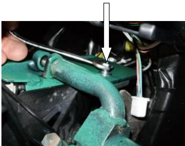
Зафиксировать защиту тяг на лапке замка
