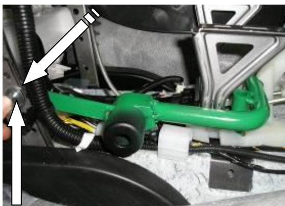
Открутить болт, установить замок, закрутить болт, зафиксировав его гайкой с другой стороны стойки
