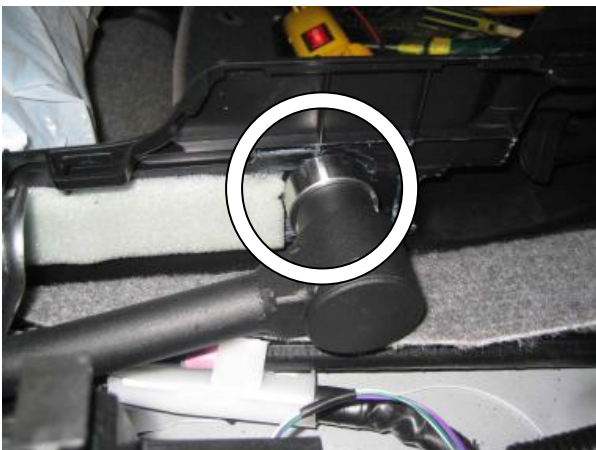
Разметить отверстие в консоли под корпус замка, используя разметочный шаблон, просверлить и расширить до 32 мм.
