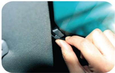
Используйте поставляемые в комплекте крепления для прокладки кабеля.
