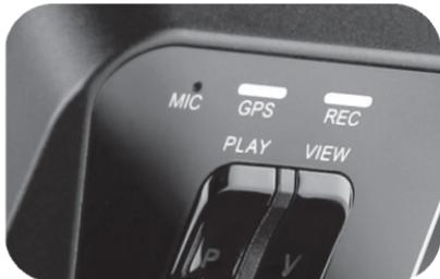
Индикатор GPS горит красным при отсутствии сигнала GPS и синим при его наличии.
