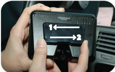
Вставьте крепление в углубление на корпусе устройства и сдвиньте его по направлению стрелки 1 до щелчка. (Для снятия устройства с крепления сдвиньте устройство по направлению стрелки 2).
